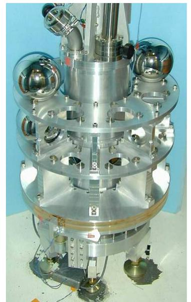
**Bild 9:** Gravitationsdrehwaage heute: Präzisionsmodell der University of Washington in Seattle (USA)
