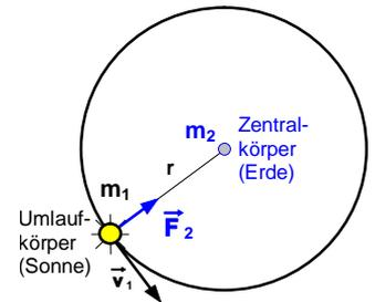
Bild 12: Zentripetalkraft  $F_2$  auf den Umlaufkörper  $m_1$
