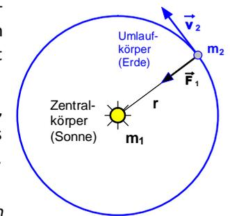
Bild 11: Zentripetalkraft  $F_1$  auf den Umlaufkörper  $m_2$
